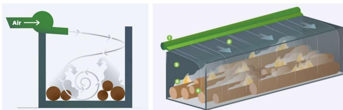
Figure 14 : Principe de l'incinérateur à rideau d'air (source : [airburners.com](http://airburners.com) lien consulté le 13 avril 2021)
